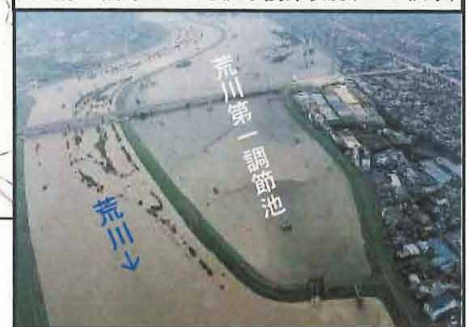
荒川第一調節池による洪水調節状況(H11.8洪水)
